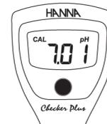
Quando "7.01" lampeggia sul display, posizionare la punta della sonda nella soluzione tampone a pH 4.01, pH 7.01 o pH 10.01.
